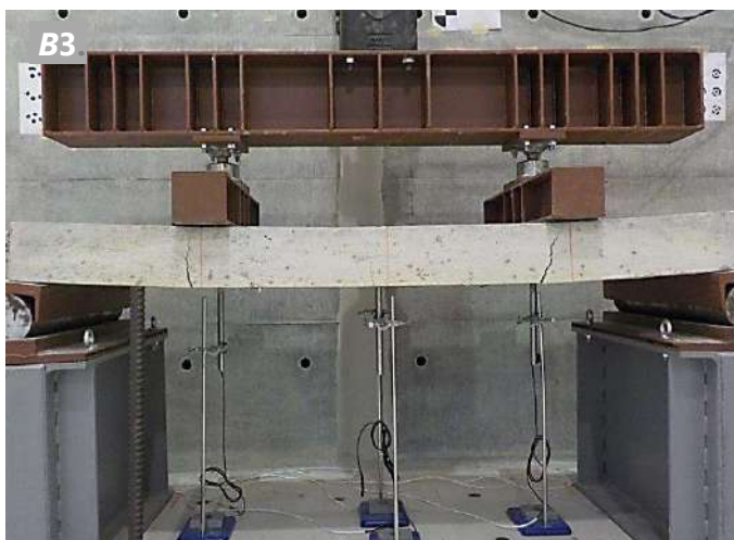
Εικόνα 6: Ρηγμάτωση και ακραία ολίσθηση στην αστοχία που καταγράφηκαν κατά τον πειραματικό έλεγχο των δοκιμών σειράς B. Σύμμικτες πλάκες B1 (α), B2 (β) και B3 (γ).
