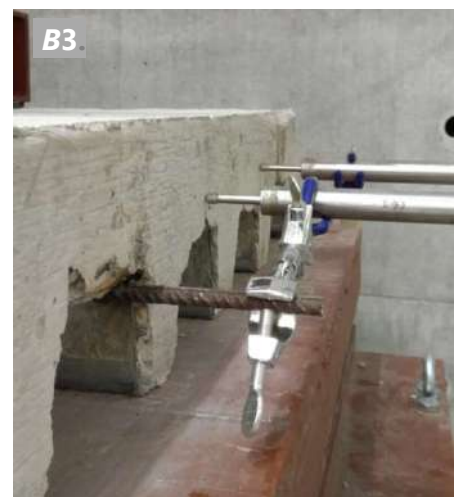
Εικόνα 6: Ρηγμάτωση και ακραία ολίσθηση στην αστοχία που καταγράφηκαν κατά τον πειραματικό έλεγχο των δοκιμών σειράς B. Σύμμικτες πλάκες B1 (α), B2 (β) και B3 (γ).
