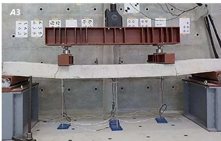
Εικόνα 5: Ρηγμάτωση και ακραία ολίσθηση στην αστοχία που καταγράφηκαν κατά τον πειραματικό έλεγχο των δοκιμών σειράς Α. Σύμμικτες πλάκες Α1 (α), Α2 (β) και Α3 (γ).
