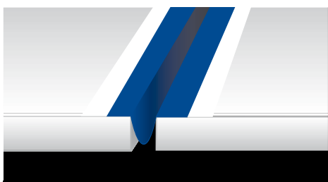
Τοποθέτηση του Mapeband μέσα σε αρμό διαστολής σε σχήμα ανεστραμμένου Ω
